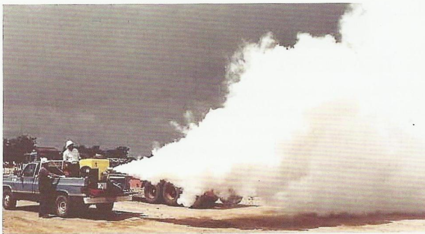
Thermal Fogging Technique 1 - 50 Microns Droplet Size
